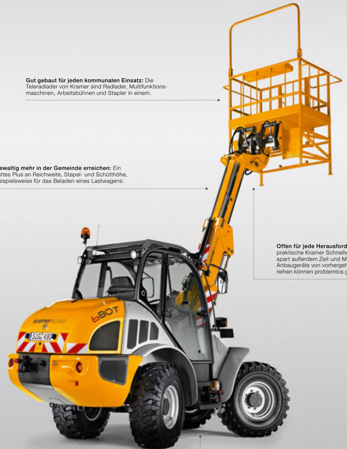
**Einen Kramer wirft nichts aus der Bahn:** Ungeteilter Rahmen für konstante Nutzlast und Standsicherheit; Allradlenkung für höchste Wendigkeit.
