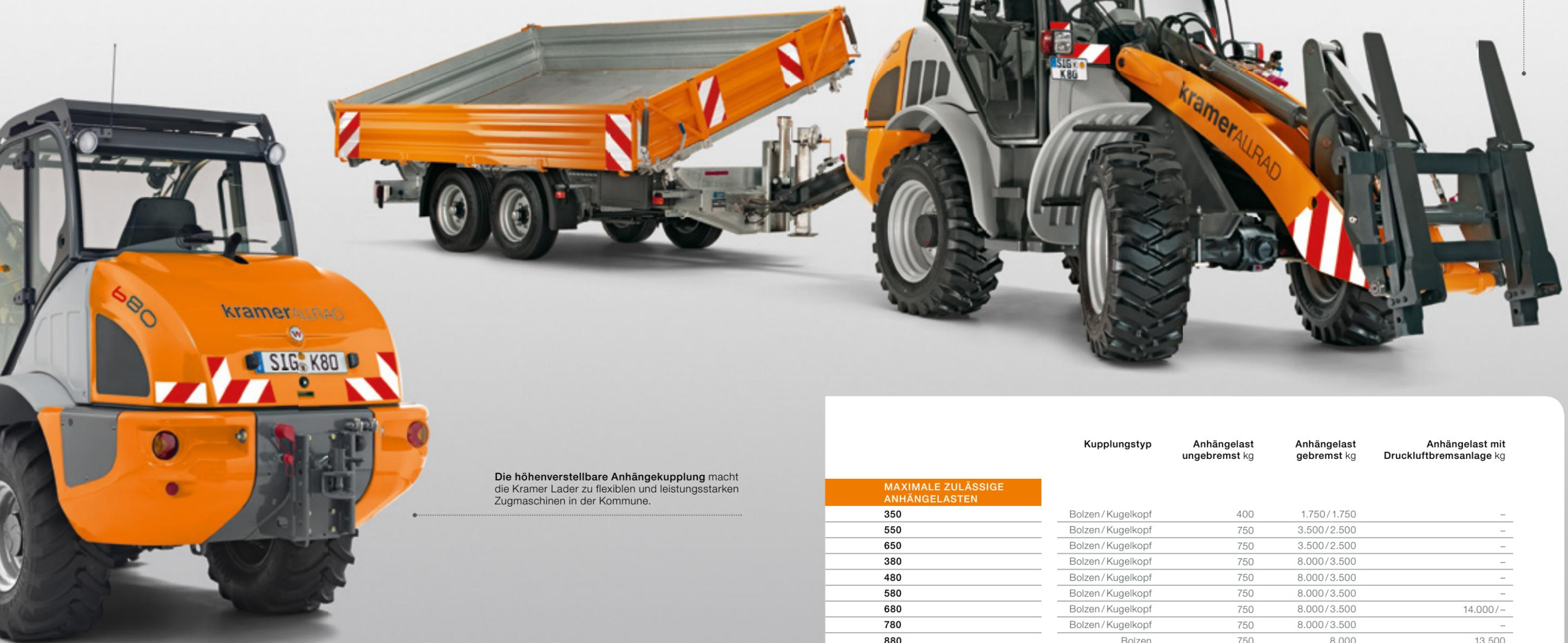
**Klappbare Gabelzinken** ermöglichen Fahrten auf öffentlichen Straßen. In dieser Transportstellung wird das zulässige Maß von 3.500 mm von Lenkradmitte zur Fahrzeugvorderkante eingehalten.
